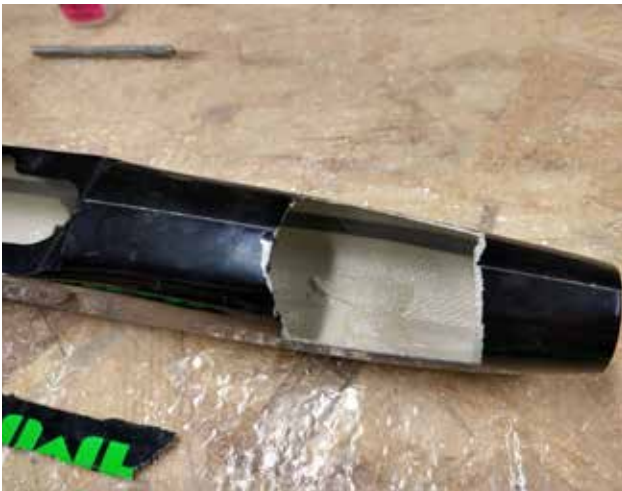
Schade aan de romp en staart
