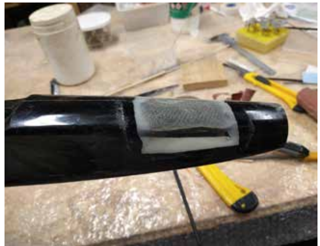
Reparatie van de rompneus
